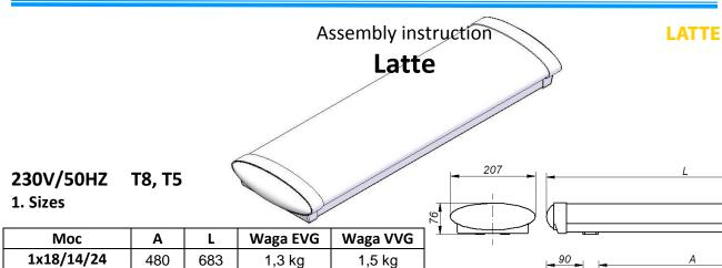
1x36/28/54 710 1293 2,7 kg 2,3 kg 1x58/35/49/80 910 1593 2,8 kg 3,3 kg 2x18/14/24 480 683 1,4 kg 1,7 kg 2x36/28/54 710 1293 2,4 kg 3,2 kg 2x58/35/49/80 910 1593 2,9 kg 3,8 kg
